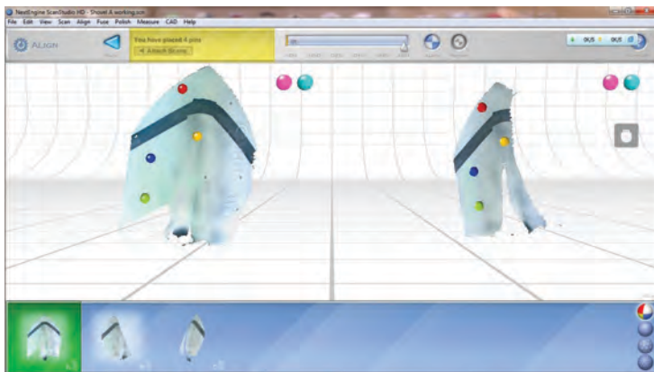
Figure 1: The three scans for each shovel were aligned with the guide of the targets in ScanStudio HD. Six centimetres from the tip of the shovel was measured and marked with masking tape before applying spray paint. Schéma 1 : Les trois balayages réalisés pour chaque pelle ont été alignés à l'aide des cibles, avec le logiciel ScanStudio HD. Six centimètres ont été mesurés depuis la pointe de chaque pelle et marqués à l'aide d'une bande de masquage adhésive, avant l'application de peinture aérosol.
